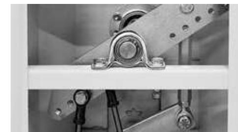
Engranajes de metal + motor no en línea resistente a los impactos (ALT6K)
